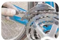
**1 - Positionner la chaîne** de façon à ce que l'axe qui dépasse du maillon extérieur soit vers vous, ceci pour faciliter la manipulation du dérive chaîne en fin d'opération !
