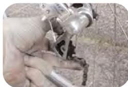
**4 -** Après passage derrière le galet inférieur, **tirer la chaîne** de façon à ce que les deux bouts se joignent entre plateau et galet. Pour éviter qu'elle ne se déplace en s'enroulant sur la roue libre, il est possible de la bloquer en actionnant la manette du dérailleur avant vers le plateau médian.
