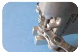
**2 - Visser la poignée** jusqu'à ce que le poinçon vienne en contact avec l'axe du maillon. Avant de continuer l'opération, **vérifier que le poinçon est bien en place**, au milieu de l'axe.
