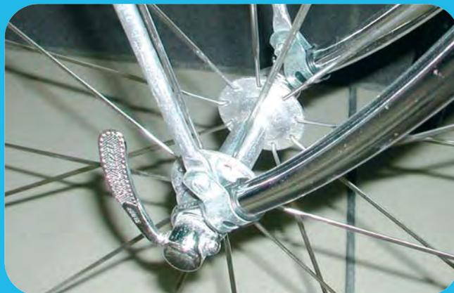
gles à l'avant et à l'arrière au niveau des pattes qui reçoivent l'axe de la roue.
