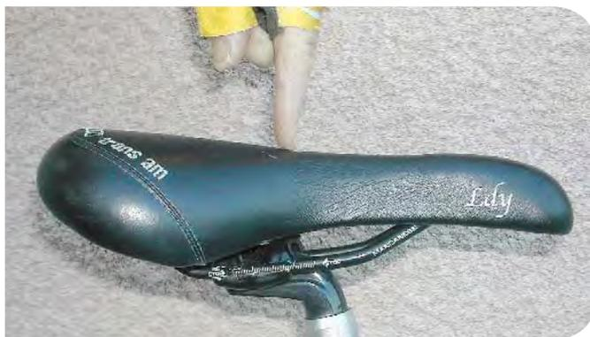
Dans un premier temps, positionner la selle de façon à ce que son centre (milieu du segment entre le bec et le croissant) soit positionné dans l'axe du tube vertical. Après avoir débloqué le serrage, monter ou descendre la tige de façon à obtenir la valeur Hs recherchée.
