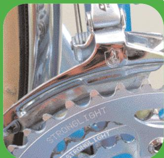
suffit pour cela de **positionner la plaque externe à l'aplomb du grand plateau** et de **vérifier leur alignement**. Ces deux opérations sont primordiales et conditionnent le fonctionnement du dérailleur.
