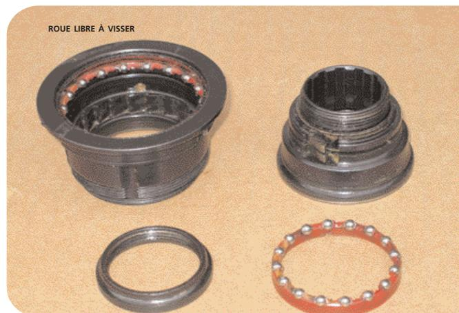
▲ Sur la partie gauche, la roue à rochets, sur la partie droite, les cliquets. ▼
