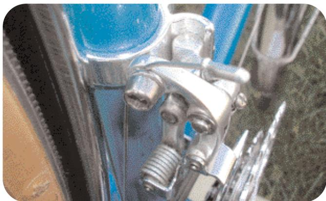
**3 - Couper le câble** en laissant dépasser un centimètre environ et placer l'embout.
