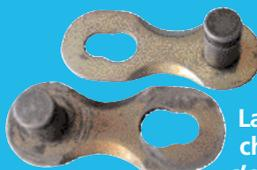
Les chaînes à maillon de fermeture spécial type SRAM (PowerLink) ou Connex (ConneX Link).
