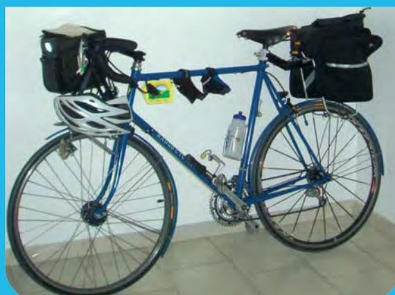
▲ Le porte-bagages avant n'est pas utilisé tandis que l'arrière est trop chargé. La charge est en arrière de l'axe de la roue et repose seulement sur la tige de selle.
