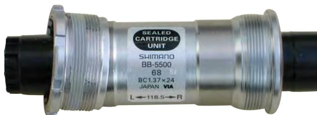
On peut regretter que les fabricants de boîtiers de pédaaliers soient limités par les dimensions trop réduites des boîtes de pédaaliers et notamment le diamètre de 35 mm. En effet une standardisation à 45 mm permettrait d'améliorer la fiabilité des boîtiers tout en assurant une meilleure tenue du brasage des tubes qui ont été surdimensionnés ces dernières années (tubes dits oversized).
