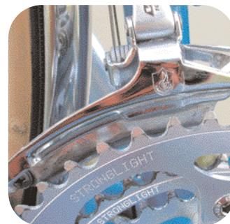
**2 - Positionner le câble dans sa vis de serrage.** Le tendre légèrement à l'aide de la pince. Cette opération ne doit pas faire bouger la biellette. **Bloquer le câble** avec les précautions précédentes. Ici le danger est d'écraser le câble et de provoquer sa rupture au bout de quelques changements de plateau.
